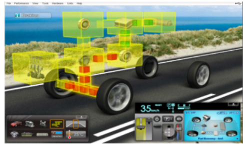
그림 10. 주행상태 - 회생제동(감속) Fig. 10 Driving condition - regenerative braking(deceleration)
