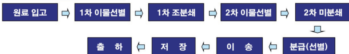
그림 5. 건설재료로 활용하기 위한 LCD 폐유리 수집, 분쇄, 분급 절차
