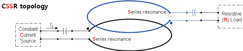
그림 11. 대표적인 코일 모듈 토폴로지 : CSSR [9] (Constant Current Source + Series Resonance + Series Resonance + Resistive Load)
