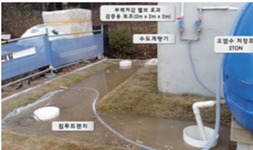
그림 3. 부력 및 물순환을 시험을 위한 Test Bed설치도
