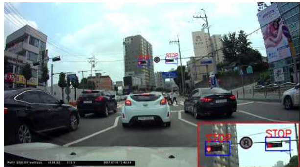
Fig. 14. Result of traffic light detection and recognition 그림 14. 신호등 검출 및 인식 결과
