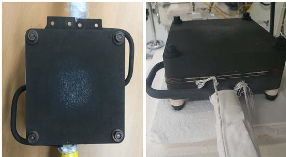
Fig. 3. SOFC 2 cell stack
