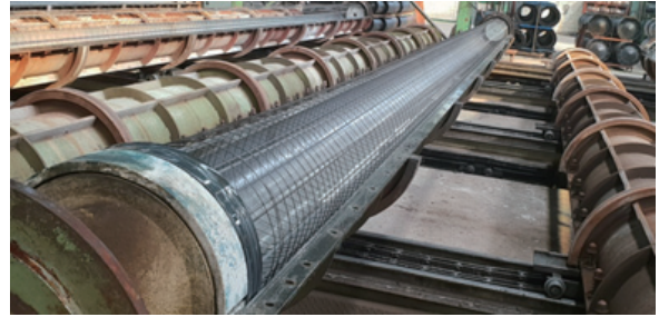
(b) 철근조립 및 몰드 준비 (외경 500 mm × 길이 15,000 mm)
