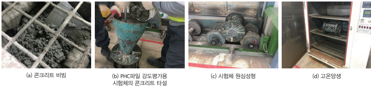
그림 3.1. 복합슬래그잔골재를 혼입한 PHC용 콘크리트의 생산 및 강도평가용 시험체 제작
