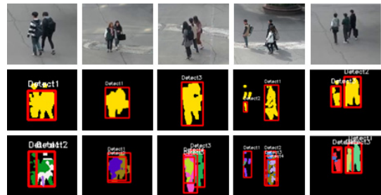
(그림 9) 객체 탐지 결과 비교 (Figure 9) Comparison of Results of Object Detection
