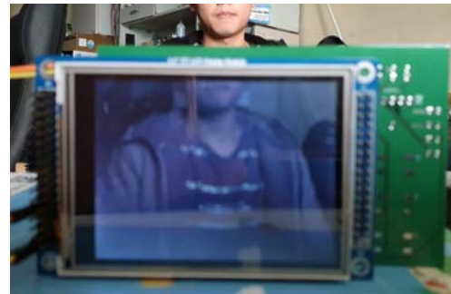
그림 21. STM32F 카메라 구현 결과 Fig. 21. STM32F camera implementation result
