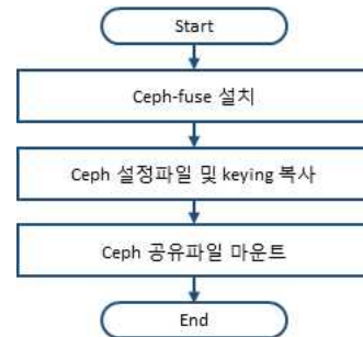
그림 7. FSA 모듈의 파일스토리지 자동 설정 진행 알고리즘 구성도
