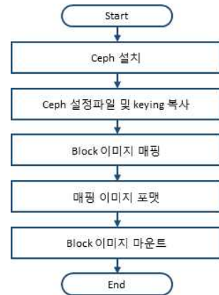
그림 10. BSA 모듈의 블록 스토리지 자동 설정 진행 알고리즘 구성도
