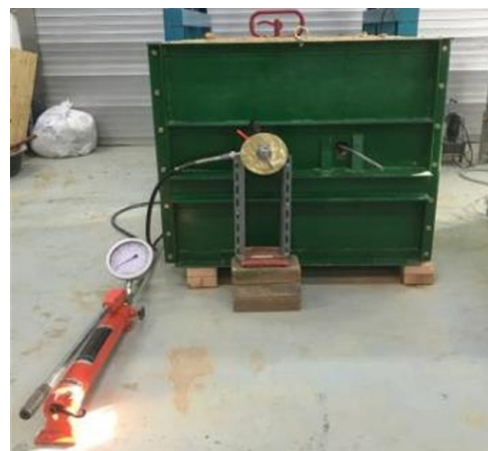
(d) View of pull-out test
