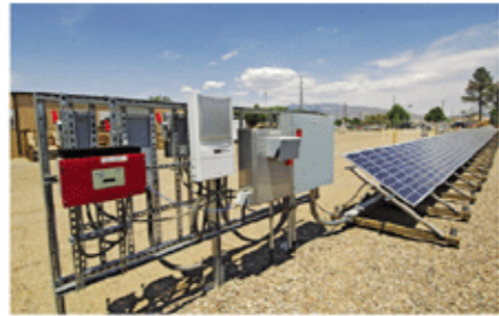
그림 3. 시험 중인 다양한 계통연계 인버터 Fig. 3. Various grid-connected inverters under test
