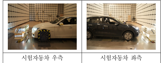
Fig. 3 시험자동차 광대역방사 측정 사진
