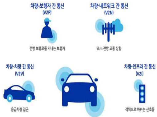
그림 8. 차량과 어느것과도 통신(V2X): 차량과 차량 (V2V), 차량과 보행자(V2P), 차량과 도로인프라(V2I), 차량과 네트워크 (V2N)
