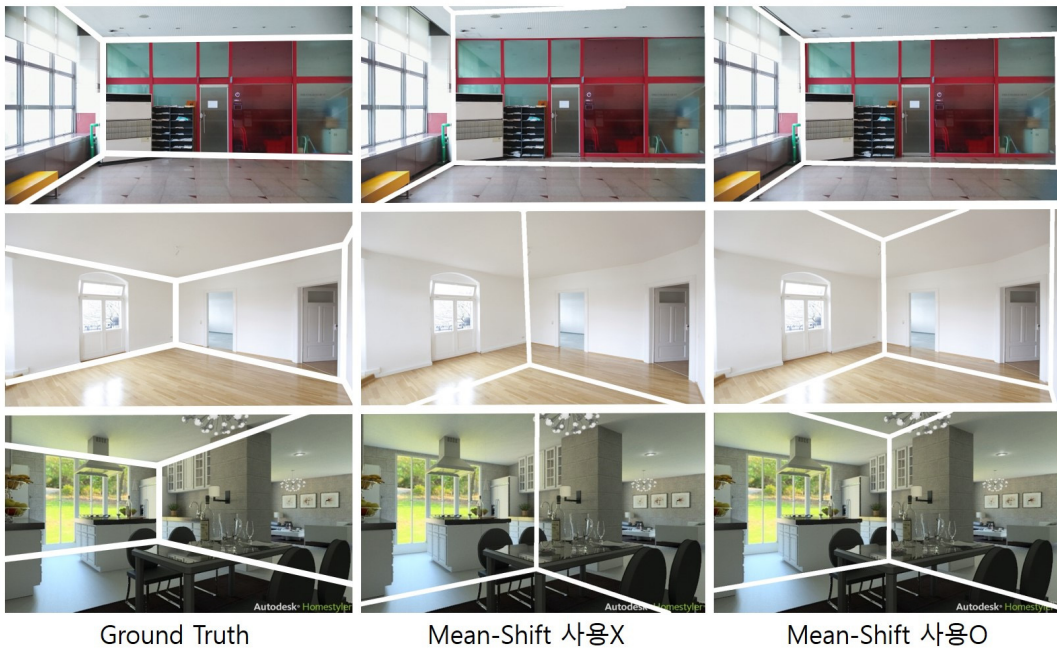
그림 9. mean-shift를 이용한 소실점 후처리 결과
