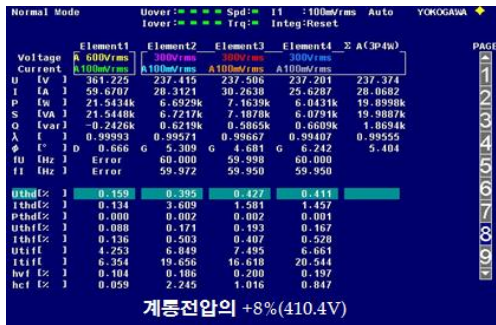
그림 4 교류 전압, 주파수 추종 범위 시험(계통전압+8%) Fig. 4 AC voltage, frequency tracking range test
