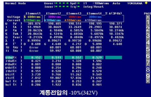
그림 5 교류 전압, 주파수 추종 범위 시험(계통전압-10%) Fig. 5 AC voltage, frequency tracking range test
