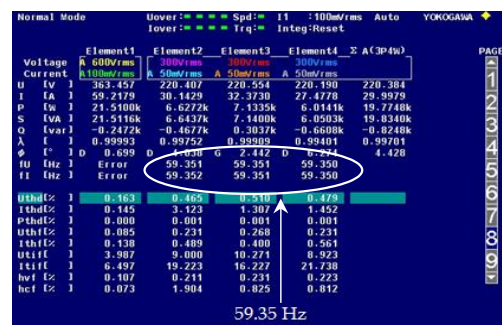
그림 7 교류 전압, 주파수 추종 범위 시험(59.35Hz) Fig. 7 AC voltage, frequency tracking range test
