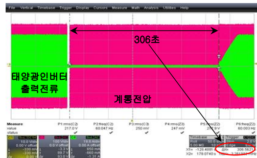
그림 2 복전후 일정시간 투입방지 기능시험 Fig. 2 Test on assigned time anti-pumping function after power recovery
