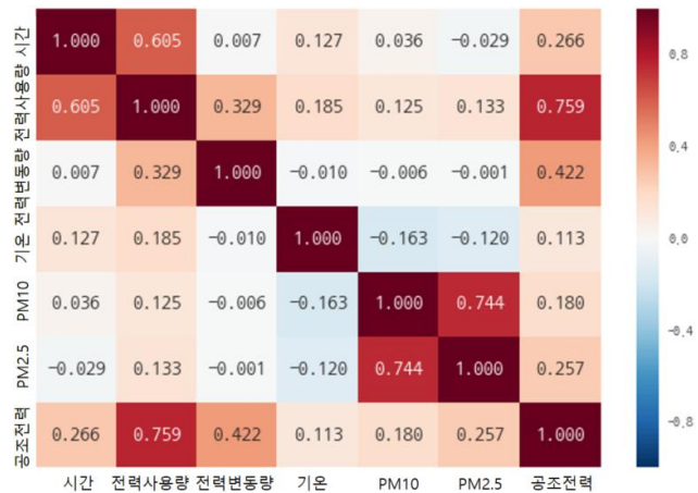
그림 8 공조부하와 다른 데이터 간의 상관행렬 Fig. 8 Correlation coefficient matrix between HVAC load and other independent variables
