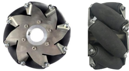
그림 3 개발된 로봇에 사용된 메카넘 휠 Fig. 3 A Mecanum wheel for the developed robot
