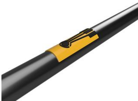
그림 4 LIG 전극 유연성 테스트 실험 모식도 Fig. 4 Flexibility test illustration of laser induced graphene electrode
