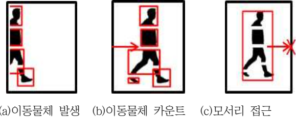
그림 5 이동물체의 수 카운트 방법 Fig. 5 Method for Counting the number of objects
