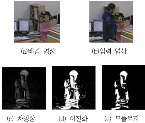
그림 2 입력된 영상의 차영상, 이진화, 모폴로지 과정 Fig. 2 Difference Image, Binarization, Morphology process Image
