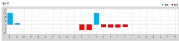
그림 17 ESS의 충전량(청색)과 방전량(적색) 데이터 Fig. 17 Amount of charging(blue colored bar) and discharging (red colored bar) power of the ESS operated in our school
