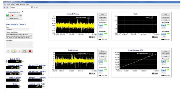
그림 11 Host PC에 표시된 HILS 실험 결과
