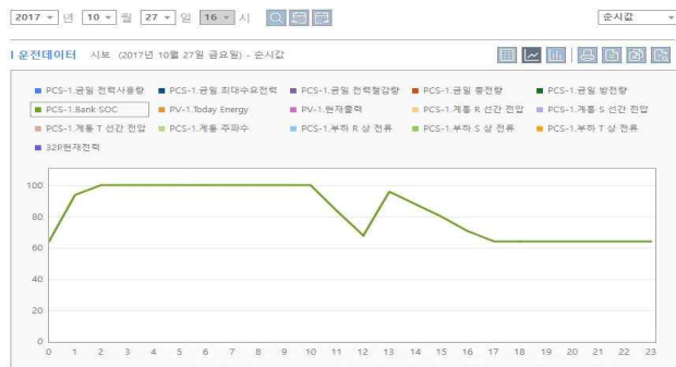
그림 18 본교에서 운영 중인 ESS의 SoC 상태 파형 Fig. 18 SoC waveform of the ESS operated in our school
