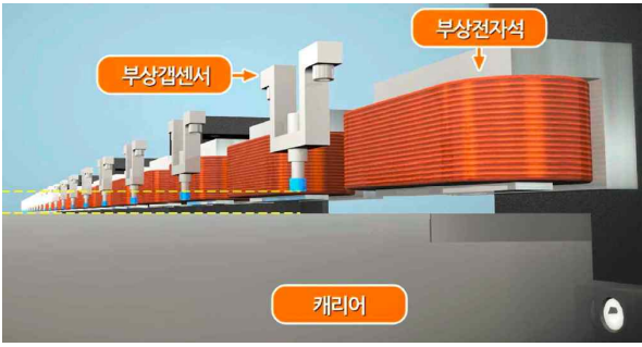
그림 3 초정밀 자기부상 물류 이송장치의 부상 전자석 및 공극 센서
