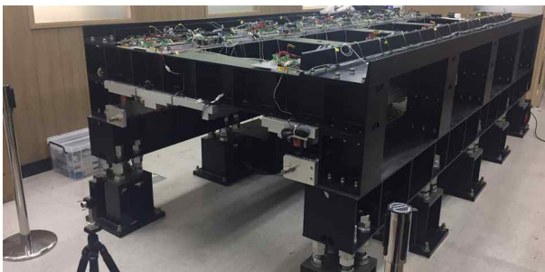
그림 1 초정밀 자기부상 물류 이송장치
