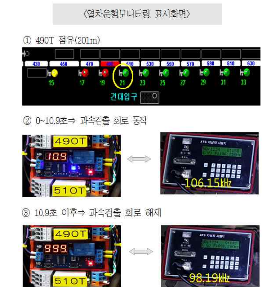
그림 13 과속방지 방호 ATS 지상장치의 작동 모니터링 및 주파수 측정
