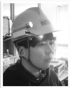
그림 10. 가스 누출 경보 IoT 장치 안전모 장착 Fig. 10 Gas leak alarm IoT device helmet mounted
