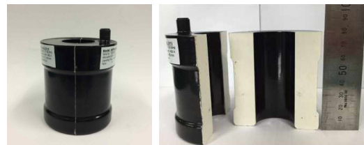
그림 3. 제작된 유도성 연결장치의 구조 Fig. 3 The structure of the inductive coupler
