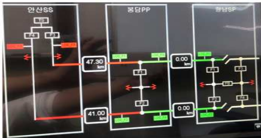
그림 12 실제 고장지점 41.237km Fig. 12 Fault location at 41.237 km
