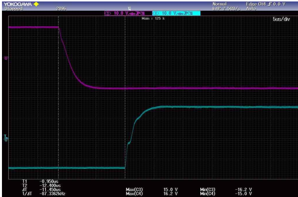
그림 6 PWM 컨버터 주회로 소자 게이트 출력전압 측정 시험 (U, X상 IGBT 스위칭)
