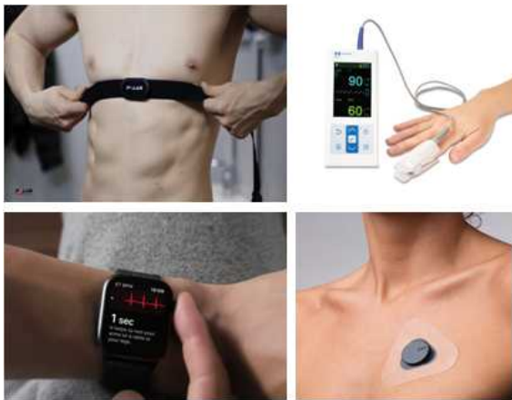
그림 1 심장활동을 측정하기 위한 대표적인 웨어러블 장치들 Fig. 1 Typical wearable devices for measuring heart activity
