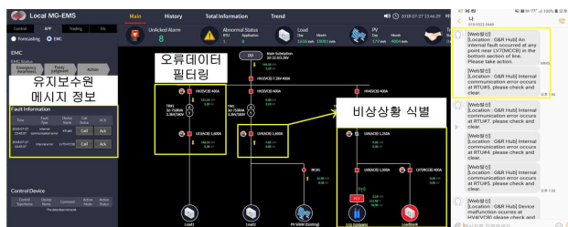
그림 9 MG 내부 비상상황 발생에 대한 자율운영 결과 Fig. 9 Operation results for inside emergency
