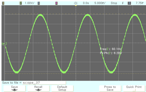
그림 4. 인버터 출력파형 Fig. 4 Output waveform of inverter
