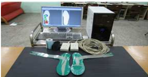
그림 1. 압력감지 센서를 부착한 스티커즈형 운동화 Figure 1. Sneakers equipped with pressure sensors
