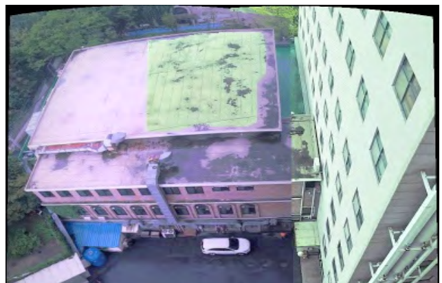
그림 15. 배경과 물체의 구분이 명확하지 않는 영상들의 스티칭 결과 Fig. 15. The stitched image when there is no clear division between background and objects
