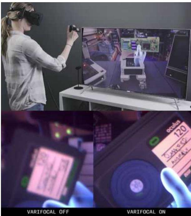
그림 1. 오쿨러스가 개발 중인 HMD ‘Half Dome’ 가변초점 기능 (그림 출처: https://www.oculus.com )
