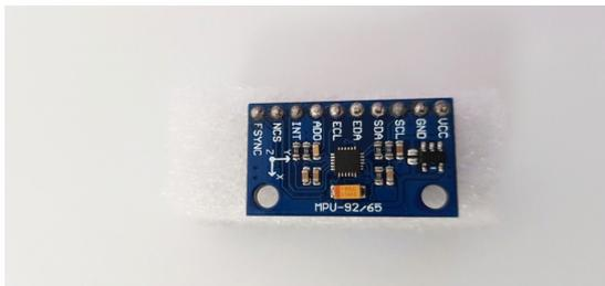
Fig. 5 MPU-9250 Sensor
