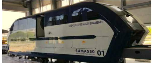
그림 10. 550km/h급 초고속자기부상열차 시제 차량
