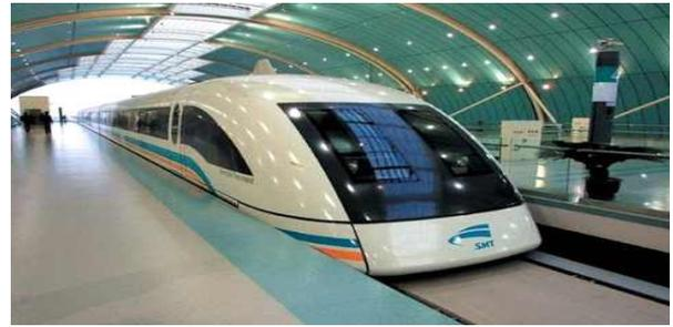
그림 4. 중국 상하이에 운행중인 독일의 초고속 자기부상철도(독일 Transrapid)
