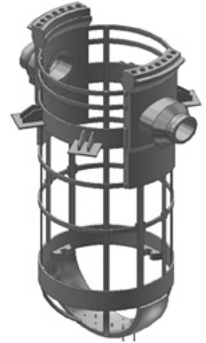
〈그림 2〉 고리 1호기 원자로 압력용기 해체 기술 개발을 위한 실증 Mockup 시설 (좌 : 플랜지, 입·출구 Nozzle, 상부 Shell 및 Insulation 절단 시편 장착 - 고리 1호기와 동일 크기) (우 : 압력용기 전체 골격에 부위별 절단 시편 장착 - 고리 1호기와 동일 크기)
