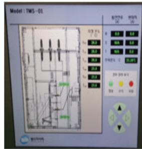
도체접속부 정상, 180도 풀림, 360도 풀림 설정 후 시험
