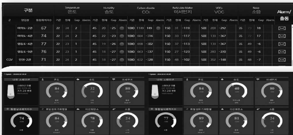
그림 6. 실내공기질 관리를 위한 통합관리 시스템 사례
