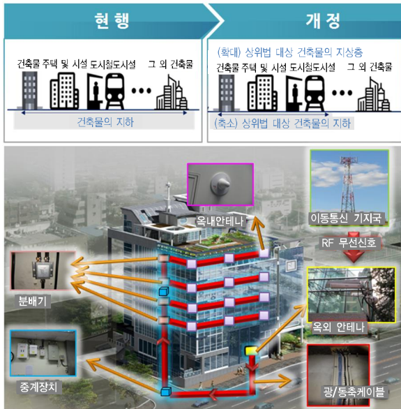
(그림 4) 구내용 이동통신설비의 설치
