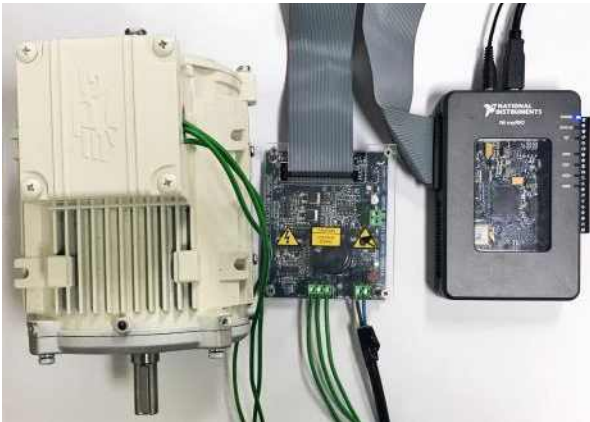
그림 7 회전자 고장 진단 시스템의 구성 Fig. 7 System for detecting rotor bar faults
