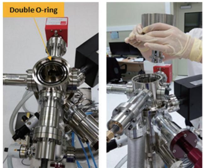
[Fig. 8] Double O-ring 방식의 전자총 기계식 정렬
