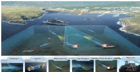
그림 1. 기뢰제거용 무인잠수정 운용개념도 Fig. 1 Operation concept of mine disposal UUV
