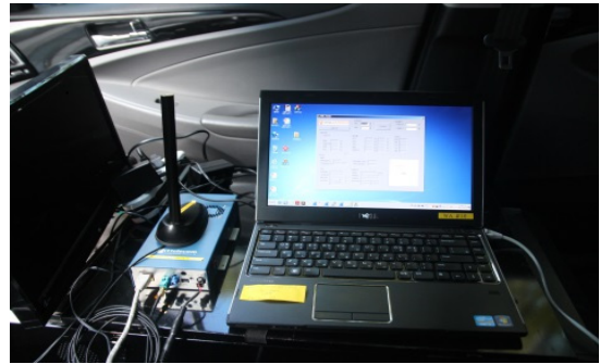
Fig. 7 BSM 검증 툴의 차량 설치
