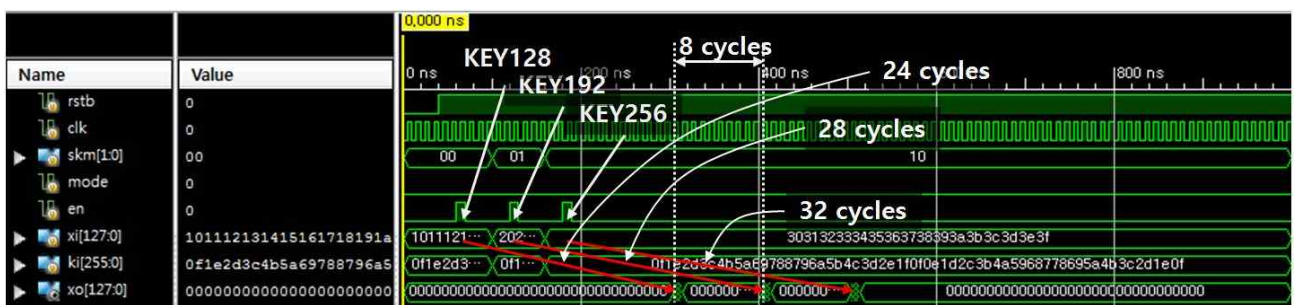
그림 9. 암호복호화 파이프라인 LEA의 연속 데이터 암호화 동작 시뮬레이션
