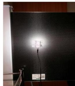
그림 4. Piranha 657 External detector 검출기 부착
