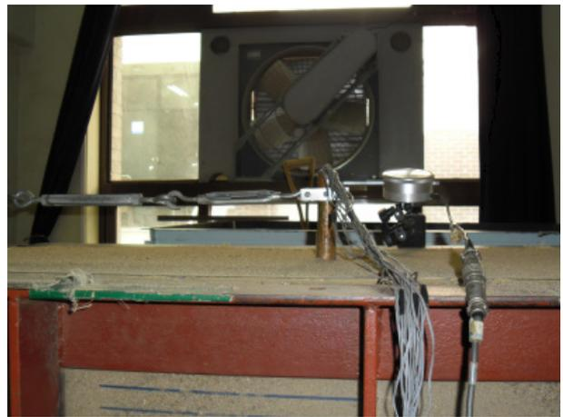
(d) Installing the displacement measuring instrument
