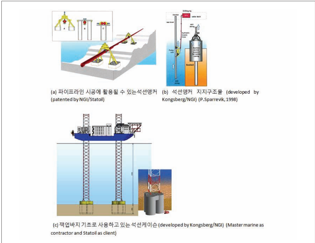
그림 7. 해상구조물에 석션 앵커 (석션 기초) 적용성 가능성
