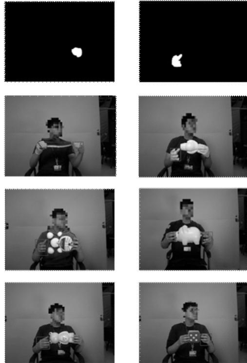
그림 7. 접촉 상태 변화 감지 결과, (1행) 검출된 손 영역, (2~4행) 접촉 상태 변화가 감지된 프레임에 검출된 손 영역을 표시한 이미지
