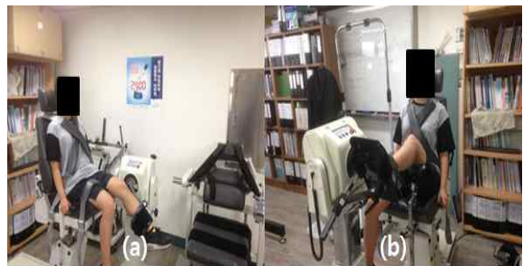
그림 1. 불균형 피험자 선출을 위한 등속성 관절토크 검사 (a)슬관절, (b)족관절 Fig. 1. Isokinetic joint torque test for estimating the muscle strength imbalance in left and right legs (a) : knee joint, (b) : ankle joint
