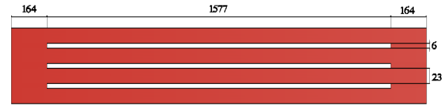
그림 11 최종설계된 2.5 MVA 몰드변압기의 Tie-plate (slot폭: 6 mm, slot간격: 23 mm)
